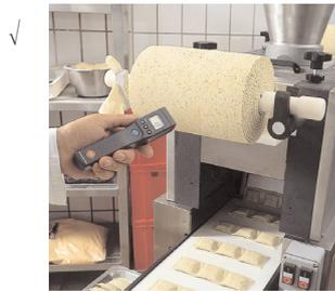
✓ ...für sich in Bewegung befindliche Teile, z. B. laufende Papierbahnen, drehende Reifen, laufende Blechbahnen etc.
